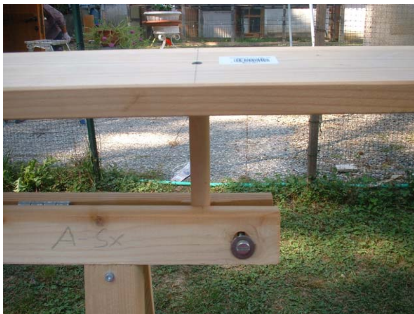
ASSEMBLAGGIO DEL SUPPORTO TAVOLO SUL CAVALLETTO
