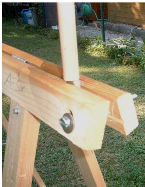
ASSEMBLAGGIO DEL SUPPORTO TAVOLO SUL CAVALLETTO
